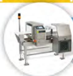
Equipos de inspección de rayos X y radiofrecuencia para detección y rechazo de contaminantes en alimentos y la industria en general
